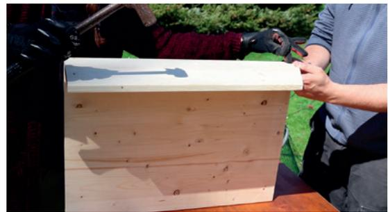
Um die Bretter dauerhaft zu befestigen, brauchst du die Holzschrauben. Damit das Holz nicht bricht, kannst du mit einem dünnen Holzbohrer Löcher für die Schrauben vorbohren. Dasselbe noch auf der anderen Seite und schon kannst du die Bretter aneinanderschrauben.
